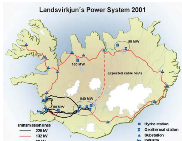
Mynd 7; Lagnaleið 132 kV strengs.
