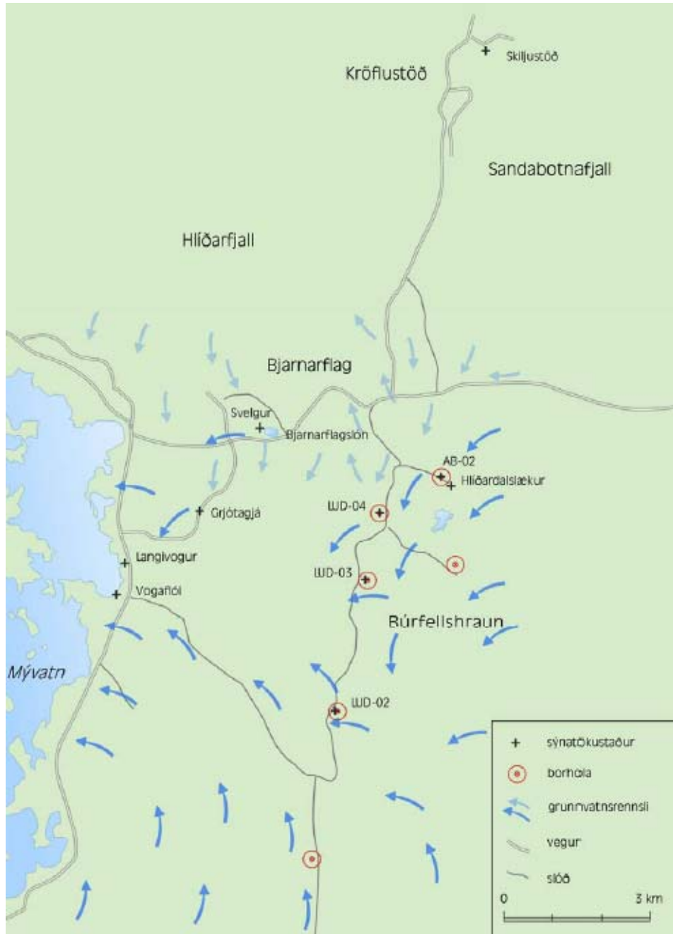
Mynd 12. Grunnvatnsflæði og sýnatökustaðir þar sem fylgst er með hugsanlegum áhrifum frá affallsvatni frá Kröflu- og Bjarnarflagsstöð.
