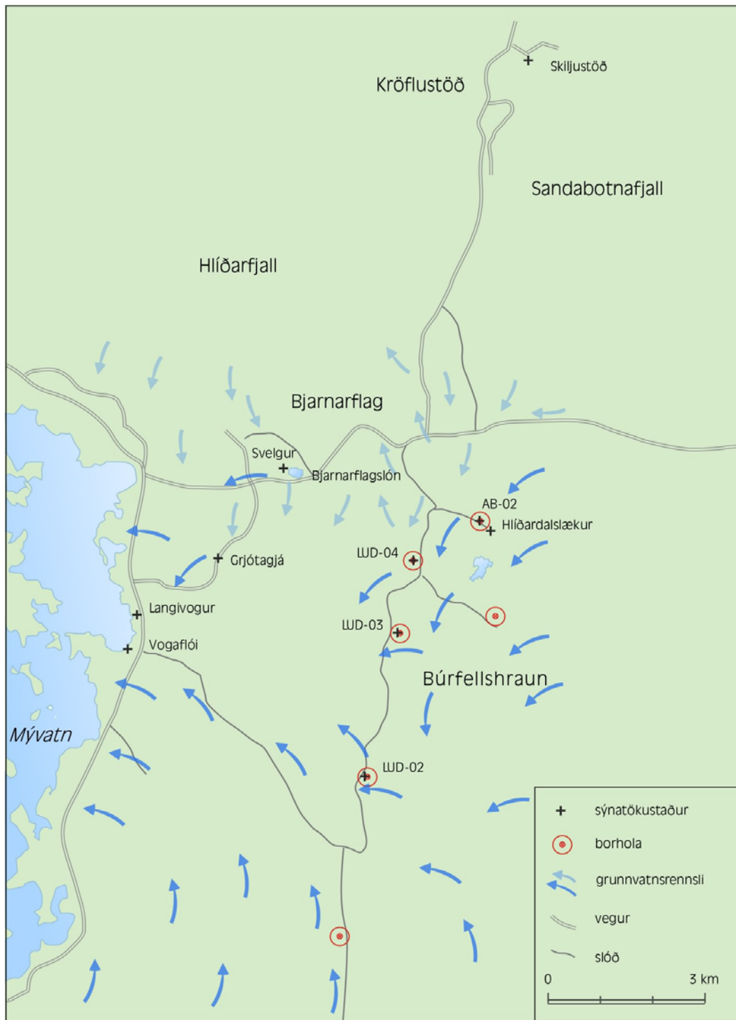
Mynd 1. Sýnatökustaðir og helstu drættir í grunnvatnsrennsli um svæðið (byggt á mynd frá Verkfræðistofunni Vatnaskilum (1999)).
